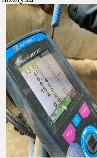
Испытания отходящих газов
