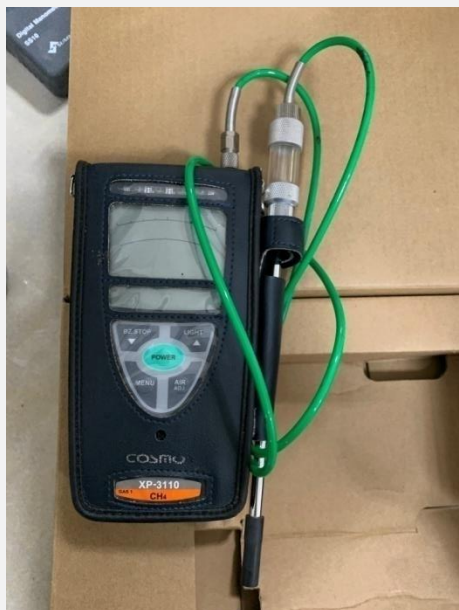
Испытания на утечку газа
